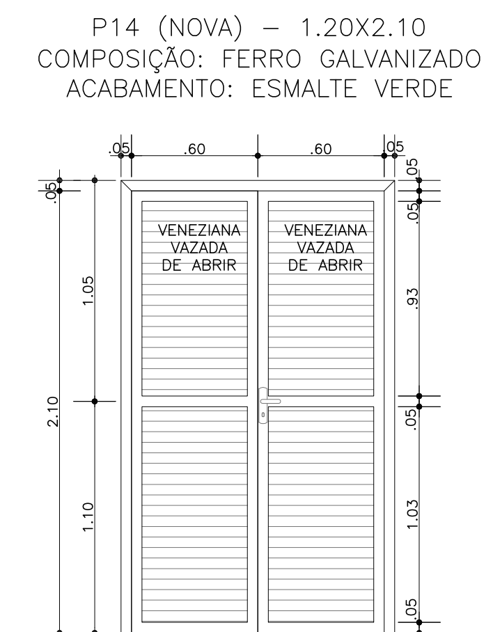
P14 (NOVA) - 1.20X2.10 COMPOSIÇÃO: FERRO GALVANIZADO ACABAMENTO: ESMALTE VERDE
