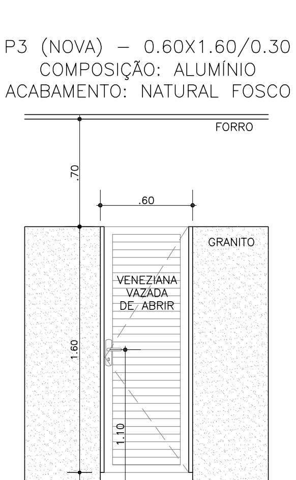
P3 (NOVA) - 0.60X1.60/0.30 COMPOSIÇÃO: ALUMÍNIO ACABAMENTO: NATURAL FOSCO
