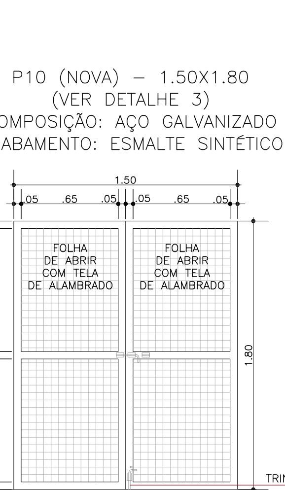
P10 (NOVA) - 1.50X1.80 (VER DETALHE 3) COMPOSIÇÃO: AÇO GALVANIZADO ACABAMENTO: ESMALTE SINTÉTICO
